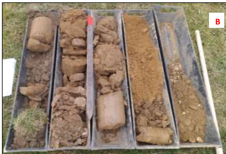
Obr. 3A: Vrtné práce na nevystrojených sondách řady S (celkový počet 95 ks) do hloubky 5 m pod terén
