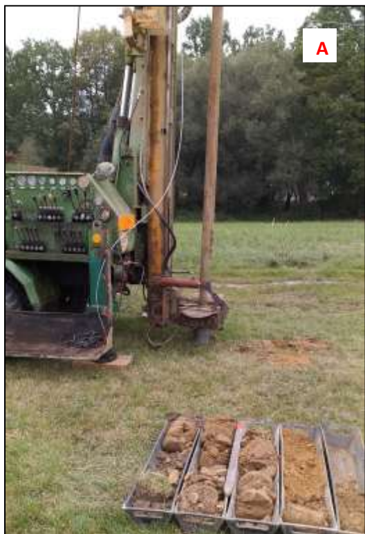
Obr. 3A: Vrtné práce na nevystrojených sondách řady S (celkový počet 95 ks) do hloubky 5 m pod terén
