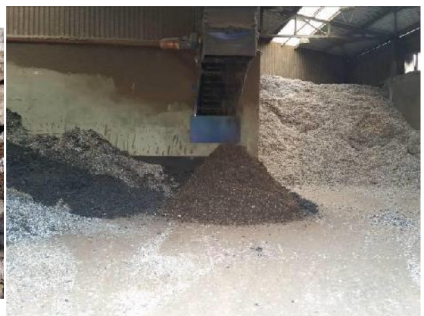
Obr. 30: Surovina pro výrobu produktu ASAPAL, která vznikla po úpravě odpadů
