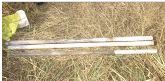
Obr. 22: Profil skládkou alfa a beta izomerů HCH (bílá hmota - odpadní izomery HCH)
