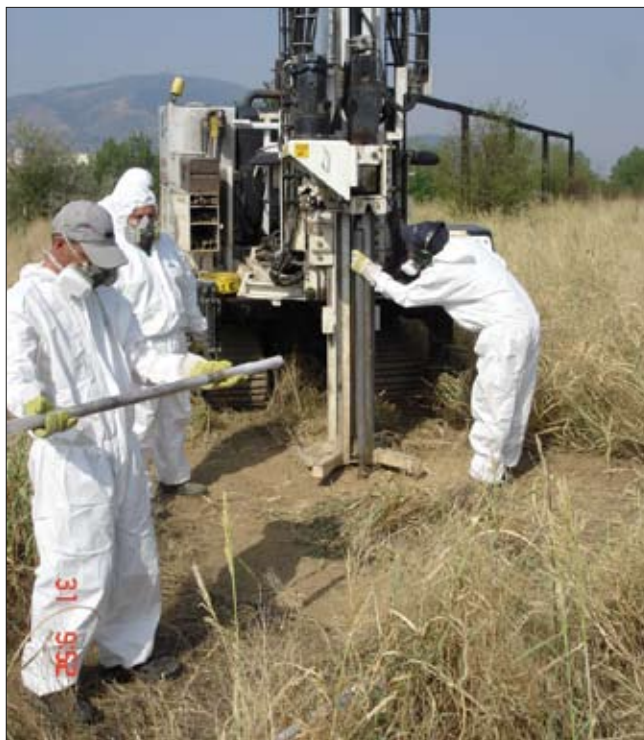
Obr. 18: Hloubení sond a odběry vzorků na skládce alfa a beta izomerů HCH
