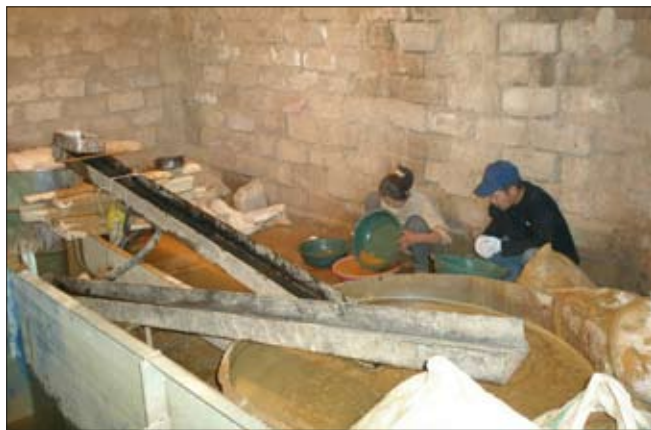
Obr. 28: Úprava podrcené a amalgamované rudy v Baruuncharaa probíhala značně primitivní technologií. V prostředí silně kontaminovaném rtuť pracují i ženy a dospívající mládež.
